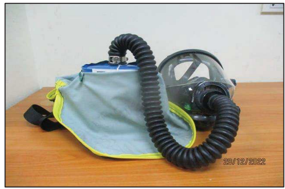
หน้ากากกรองสารเคมีชนิดเต็มหน้า (พร้อมไส้กรองก๊าซไฮโดรเจนไซยาไนด์)
